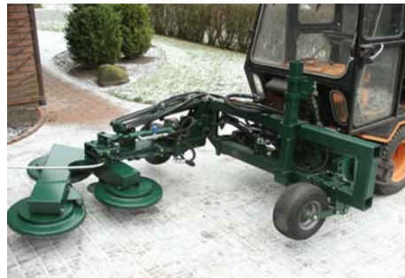
Billede 11: Pæleklipper i transportstilling vandret
