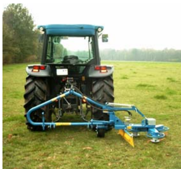
Billede 12: Pæleklipper i arbejdsstilling i bagmontering
