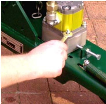
Abb. 29: At løsne skruer på hydraulikmotoren
